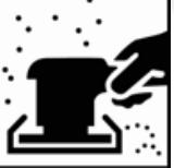
2К Эпоксидные грунты – до 12 часов без шлифования, по истечении 12 часов отшлифовать Р320.
